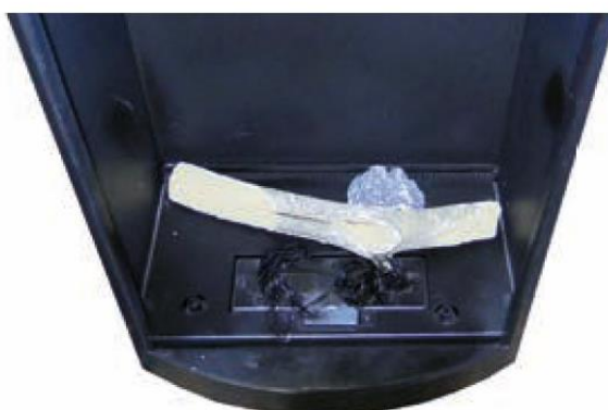
Legg kubbe nr (02) bak brenneren og inntil kubbe (05)
